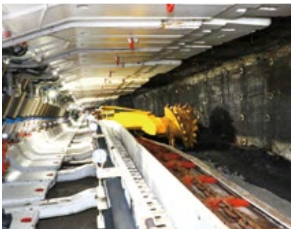
▲ 蒙大矿业井下智能化工作面自动割煤机现场作业
